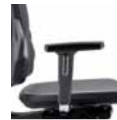
Nr. 195/795 Multifunk- tionsarmlehnen, Auflagen PU, höhen- (10 cm), brei- ten- (5 cm) und tiefenver- stellbar (4 cm); Armlehnen- träger Aluminium poliert/ n° 195/795 Accoudoirs multifonctions, manchettes en PU, réglables en hauteur (10 cm), en largeur (5 cm) et en profondeur (4 cm); supports d'aluminium poli
