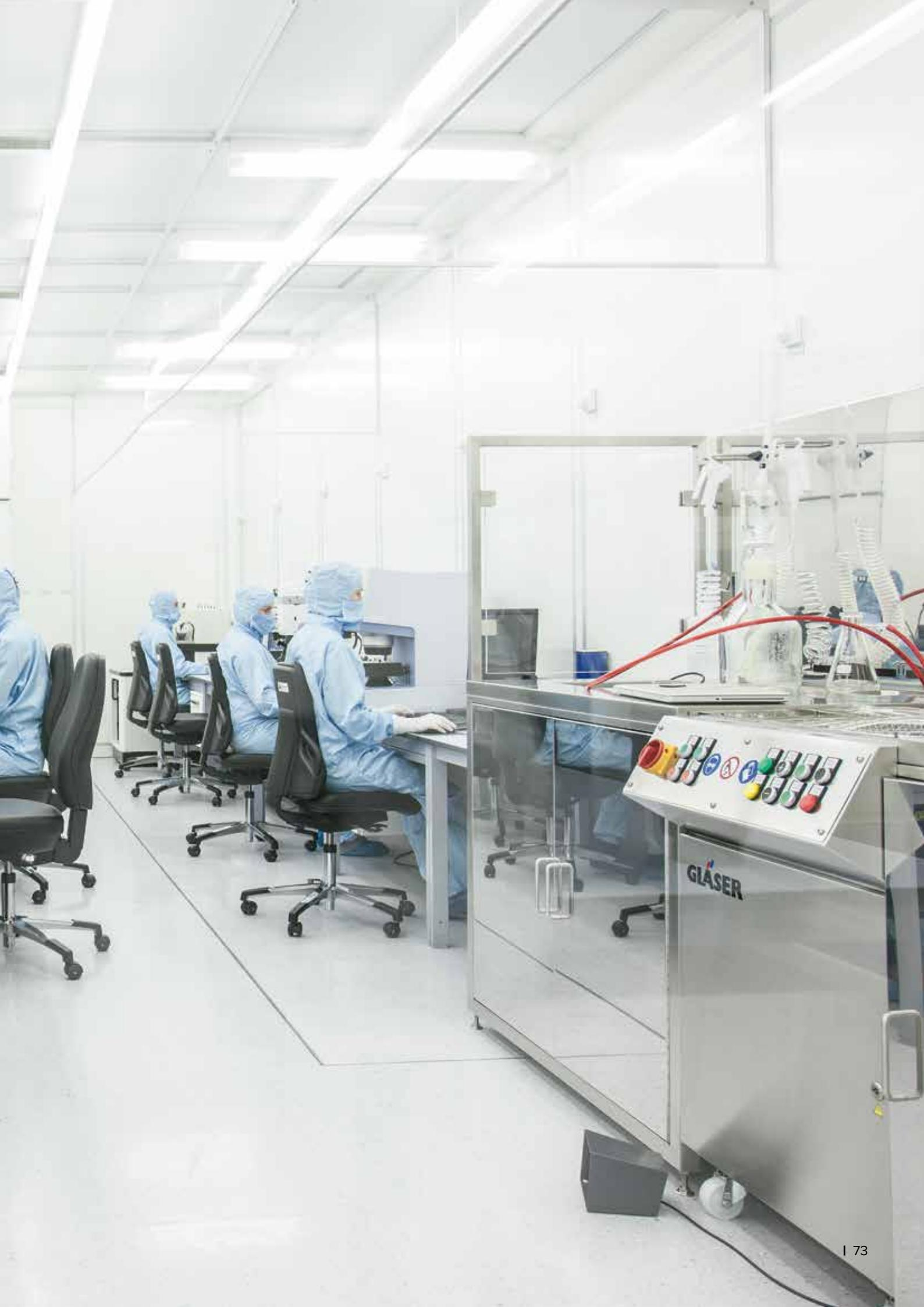
**Reinheit und Funktionalität.** Der Reinraum erfordert äußerste Sorgfalt bei der Möblierung. Neben der Notwendigkeit einer äußerst niedrigen Emission selbst kleinster Partikel ist die elektrostatische Ableitfähigkeit meistens eine wichtige Anforderung. Glatte Oberflächen, versiegelte Polster, verdeckte Mechaniken und ableitfähige Materialien: Unsere für den Reinraum entwickelten Modelle werden all diesen Ansprüchen hervorragend gerecht.
