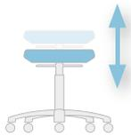
Sitzhöhenverstellung durch Gasfeder mit Ringauslösung
