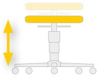
Sitzhöhenverstellung durch Gasfeder mit Ringauslösung
